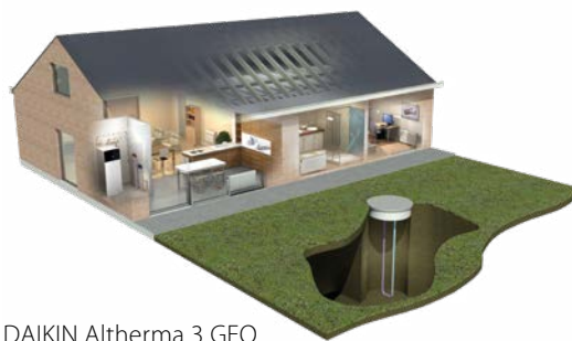
DAIKIN Altherma 3 GEO mit Erdsonde
